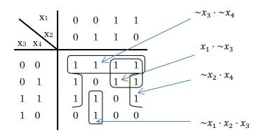
$${\sim} x_3 \cdot {\sim} x_4 \vee x_1 \cdot {\sim} x_3 \vee {\sim} x_2 \cdot x_4 \vee {\sim} x_1 \cdot x_2 \cdot x_3$$
